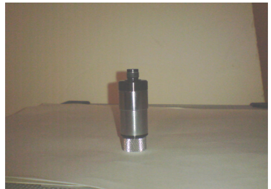
ファインダーのライト。 上側が光源、下側がスイッチです。 電池は LR44 を 2 個使用します。
