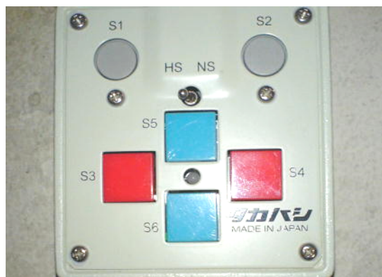
赤道儀のハンドコントローラー。 リモコン感覚で望遠鏡を動かせます。
